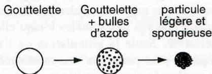
Figures 3a et b ■ Mécanismes d'instantanéisation par atomisation.
